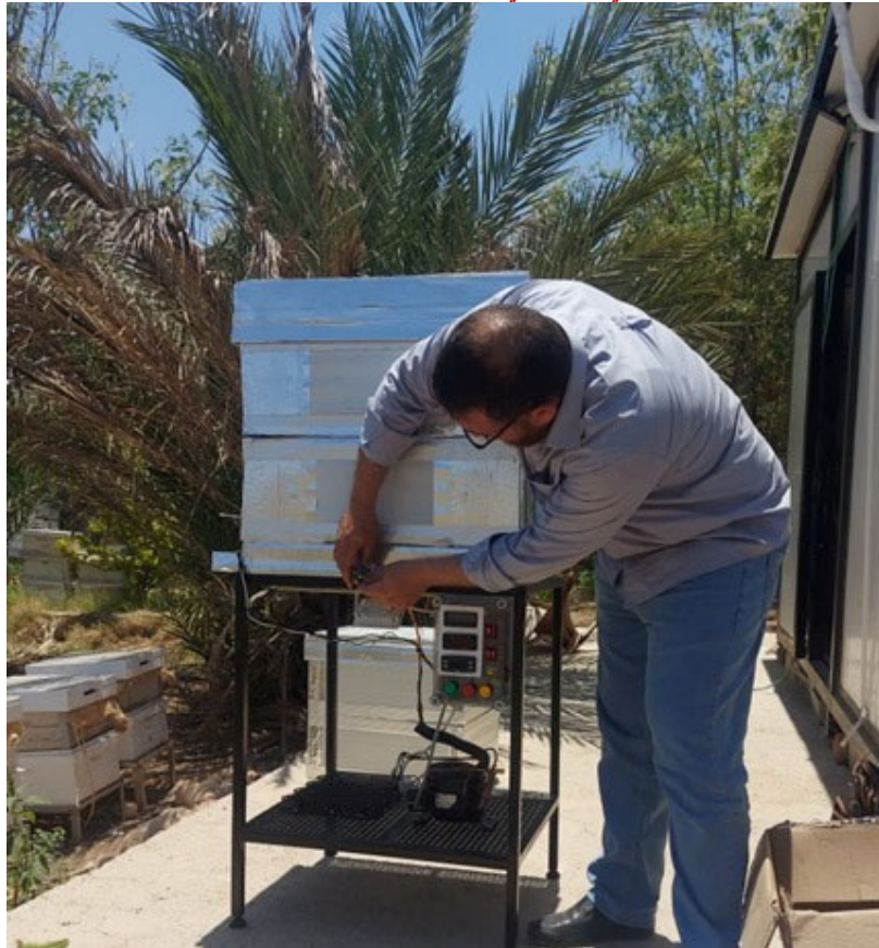
خلية النحل المتحكم بها من خلال ضبط الحرارة والرطوبة والتهوية داخل الخلية
